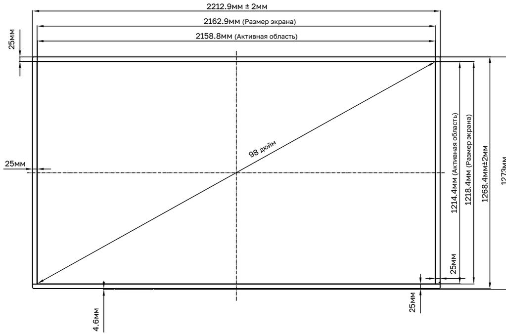
**СХЕМА ДИСПЛЕЯ (ВИД СЗАДИ)**
